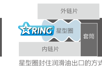
星型圈封住润滑油出口的方式
