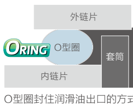
O型圈封住润滑油出口的方式
