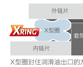
X型圈封住润滑油出口的方式
