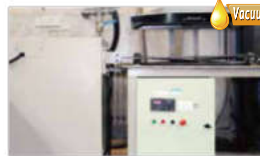
真空上油技术：利用真空泵对上油容器抽出空气，使链条零件内部空气被抽出，形成负压，使各零件缝隙中充满耐摩油脂。该项技术使链条上油均匀充分，润滑良好，很好的提高了链条的耐磨性能。
