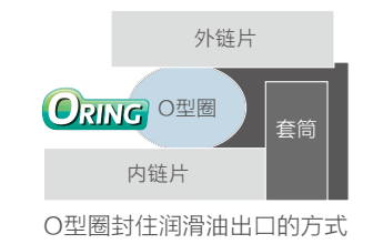
O型圈封住润滑油出口的方式
