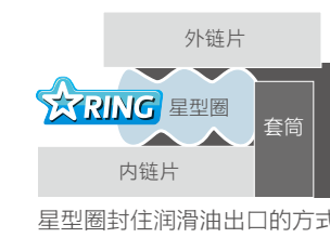
星型圈封住润滑油出口的方式
